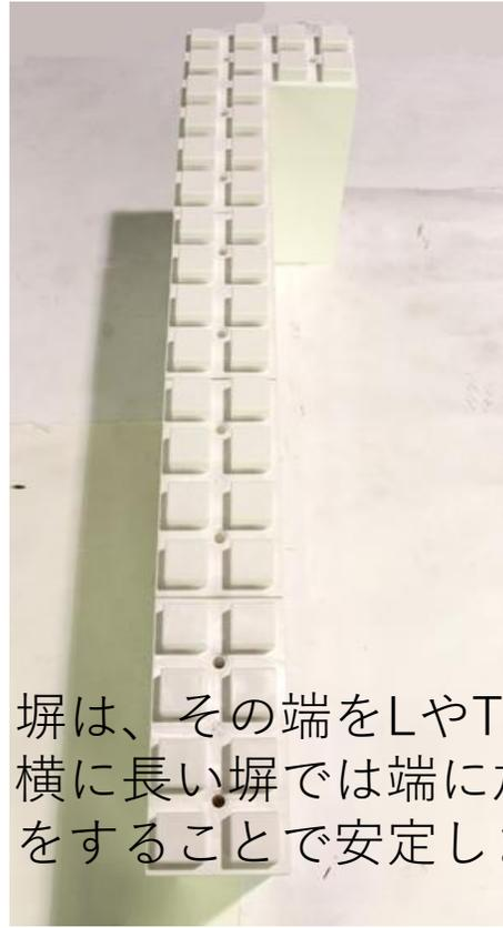
塀は、その端をLやT字型にすることで安定します。横に長い塀では端に加えて中央部分も同様の施工をすることで安定します
